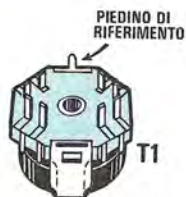
Fig.6 Il piedino di riferimento, come vedesi in questo disegno, è un piccolo terminale collegato allo schermo metallico dello stesso trasformatore.
