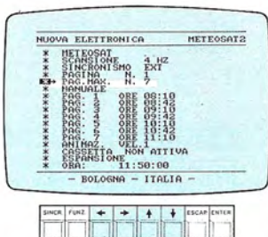
Fig.12 Spostato il cursore sulla riga "PAG. MAX.", premendo i tasti "freccie", dovrete indicare su tale riga quante pagine Max memorizzare.
