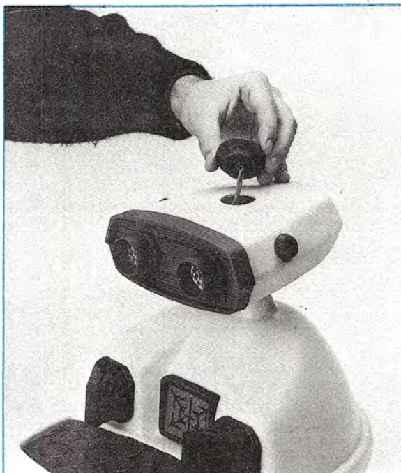
Fig.22 Non dimenticatevi, una volta saldati i fili dei due motorini, di collegare i due condensatori antidisturbo come consigliato in fig.5.
