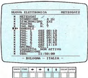
Fig.10 Per memorizzare delle immagini, è necessario togliere lo ZOOM e portare il cursore sulla riga Manuale e premere il tasto Funzione.
