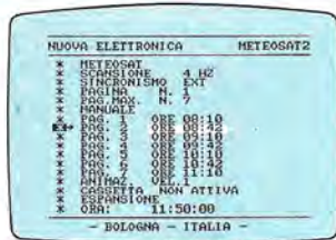
Fig.16 Spostando il cursore sulla pag.2, potrete memorizzare le ore pre-selezte per la registrazione.
